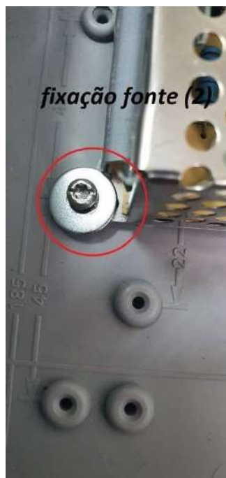
Fixação 4 - parte traseira da fonte
