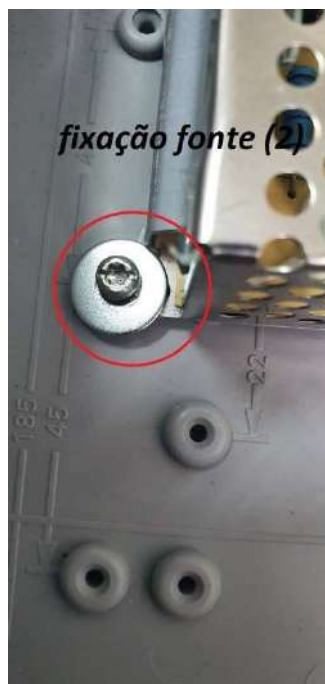
Fixação 4 - parte traseira da fonte
