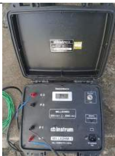
Valor da resistência do sistema encontrado em campo, 34,8m \Omega .
