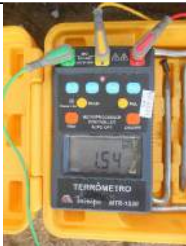
Valor de resistência do solo encontrado, 1,54Ω.
