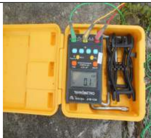
Valor de tensão elétrica encontrado em campo, 0,1V.
