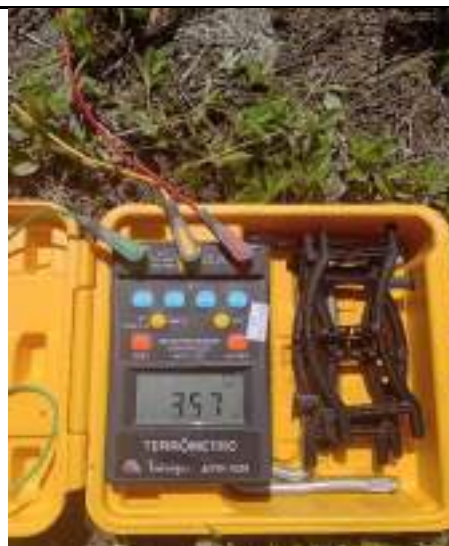
Valor de resistência do solo encontrado, 3,57\Omega .
