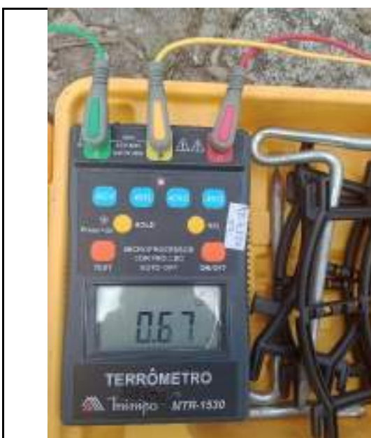
Valor de resistência do solo encontrado, 0,67 \Omega .
