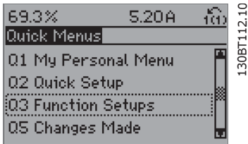
Ilustração 1.9: Passo 3: Utilize as teclas de navegação, p/ cima - p/baixo, para rolar até a opção de Setups de Função. Pressione [OK]
