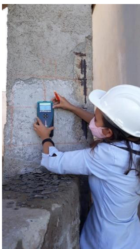
Figura 27 – Ensaio de pacometria no pilar.
