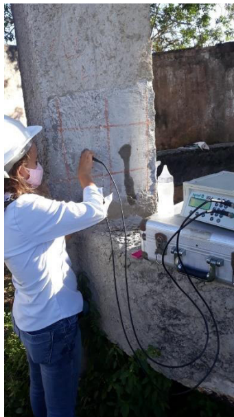
Figura 32 – Ensaio de ultrassom no pilar.
