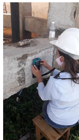
Figura 28 –Ensaio de pacometria na viga.
